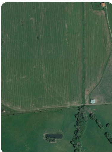
Exemplos de linhas de água redirecionadas em áreas agrícolas, desprovidas de margens e vegetação ripícola e que recebem e conduzem as águas provenientes da irrigação de culturas ou de escorrência natural 1
