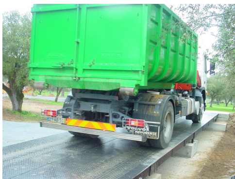
Figura 4.1 – Os veículos são pesados à entrada e à saída, de forma a determinar o peso dos RCD transportados e entregues na Unidade Piloto.
