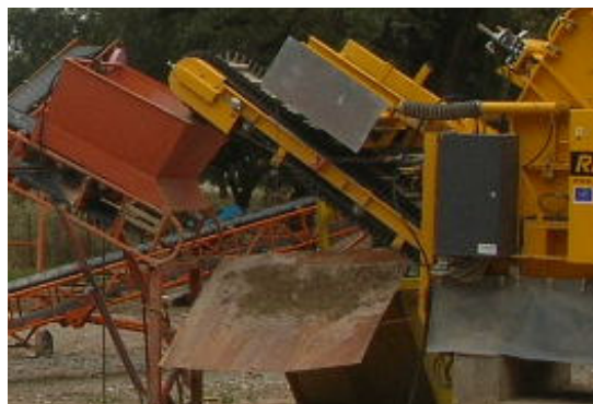
Figura 6.5 – Instalação de estrutura de protecção junto à tela do separador electromagnético.
