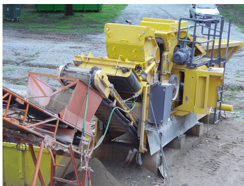
Figura 6.5 – Instalação de estrutura de protecção junto à tela do separador electromagnético.
