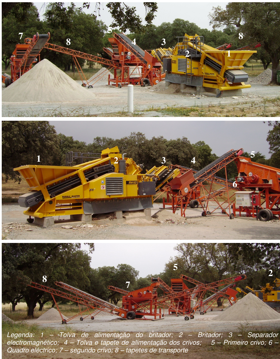
Figura 3.8 – Aspectos gerais do equipamento de reciclagem e suas componentes
