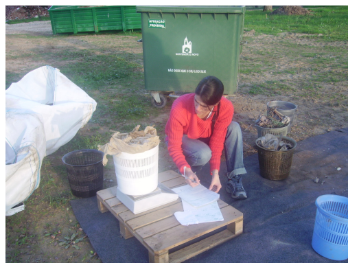
Figura 3.17 – Balança utilizada nos ensaios de monitorização efectuados.
