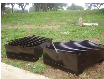
Figura 6.21 – Bacias de retenção em metal, construídas pelos serviços da CMMN, de forma a promover o correcto armazenamento de combustíveis e óleos usados na Unidade Piloto. Estas bacias encontram-se num compartimento separado na estrutura coberta instalada junto à plataforma de reciclagem.
