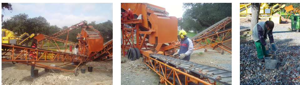
Figura 4.9 – Os agregados reciclados com granulometria > 31 mm apresentam, por vezes, alguns materiais não inertes, que devem ser removidos de forma a promover o seu aproveitamento.
