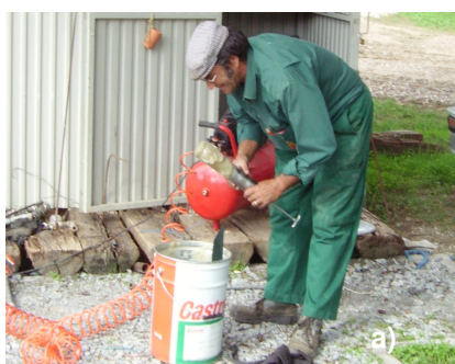
Figura 3.16 – Equipamentos/ferramentas de operação/manutenção: a) bomba de lubrificação; b) compressor; c) caixa de ferramentas diversas
