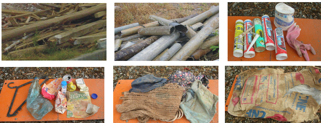
Figura 3.2 - Exemplos dos RCD não inertes que não podem ser recebidos na Unidade Piloto e que devem ser separados na origem pelos produtores dos resíduos.
