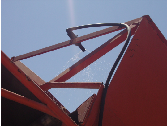
Figura 6.11 – Aspectos diversos do sistema de minimização de poeiras instalado (provisório e final)
