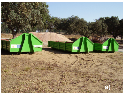
Figura 3.15 – Contentores existentes na Unidade Piloto para armazenamento temporário de resíduos (fracções não inertes): a) contentores para madeiras, plásticos e metais; b) contentores para resíduos indiferenciados.
