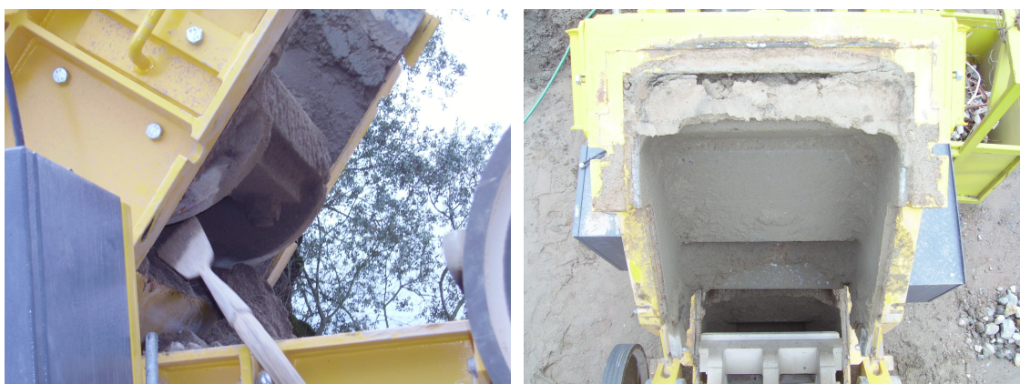
Figura 6.8 – Zona dos martelos do britador colmatada com finos, na sequência da reciclagem de RCD com humidade significativa.
