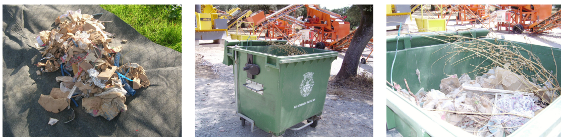
Figura 4.10 – As fracções não inertes removidas manualmente (após a 1.ª crivagem) são armazenadas temporariamente em contentores de plástico de 1000 l, sendo encaminhados para aterro.
