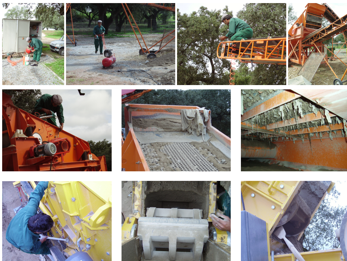
Figura 4.14 – Aspectos gerais da limpeza e manutenção do equipamento de reciclagem
