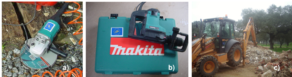
Figura 3.14 – Equipamentos para redução da dimensão dos RCD inertes: a) rebarbadora; b) martelo eléctrico; c) balde da retro-escavadora
