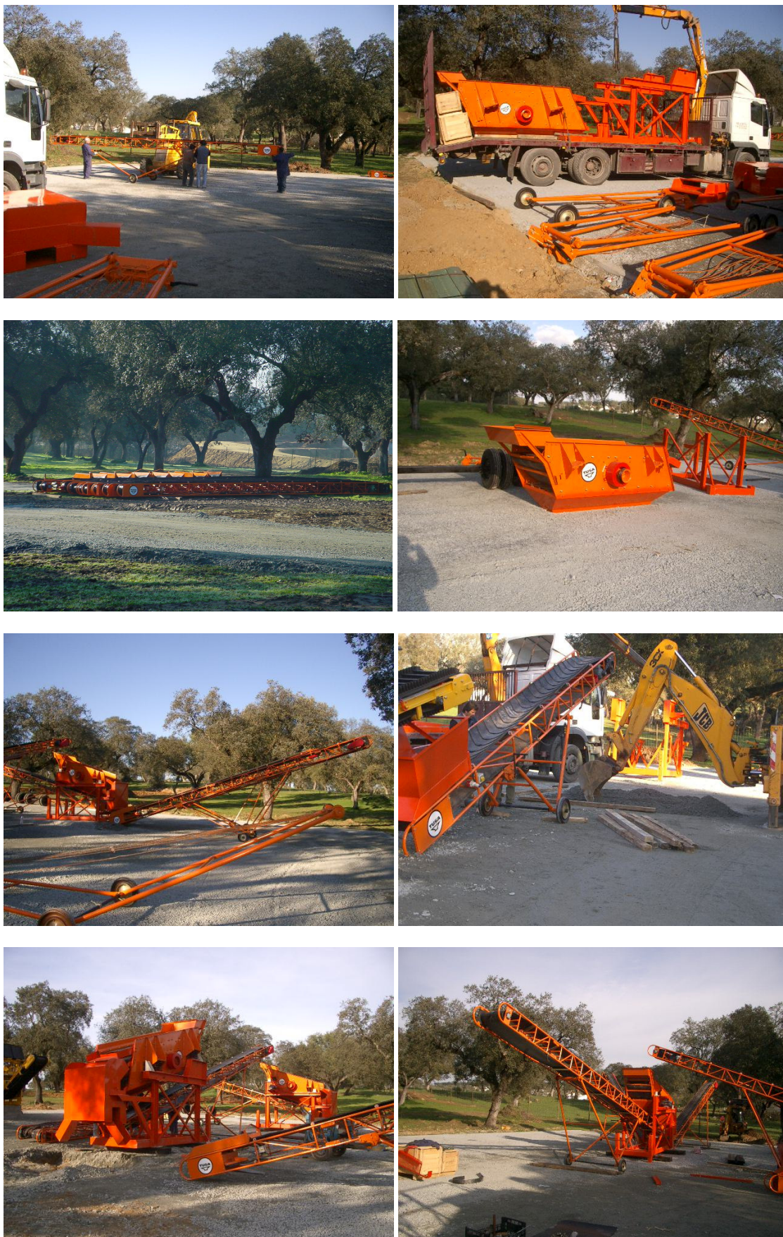
Figura 3.11 – Aspectos gerais da montagem do sistema de crivagem (crivos e tapetes)
