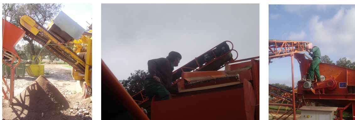
Figura 6.2 – Em alguns pontos do sistema foi necessário ajustar a altura e posição dos tapetes, de forma a evitar/reduzir a acumulação de materiais finos no solo, junto aos equipamentos.
