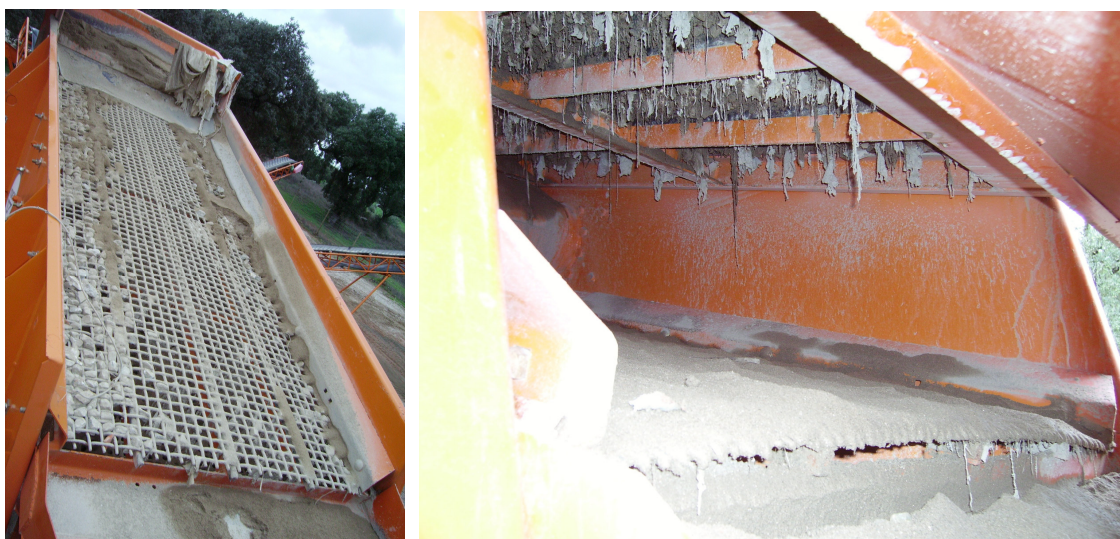
Figura 6.7 – Aspecto dos tapetes dos crivos na sequência da reciclagem de RCD com humidade significativa.
