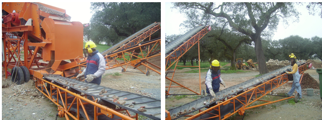
Figura 4.20 – Triagem manual das fracções não inerte no primeiro tapete do sistema de crivagem (material > 31 mm).
