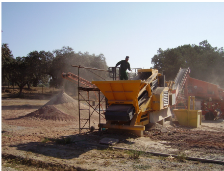
Figura 6.12 – Após instalação do sistema de minimização de poeiras, verificou-se uma redução significativa das mesmas.
