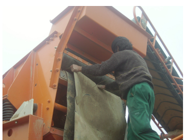
Figura 6.6 — Colocação do tapete em tela para produção de tout-venant.
