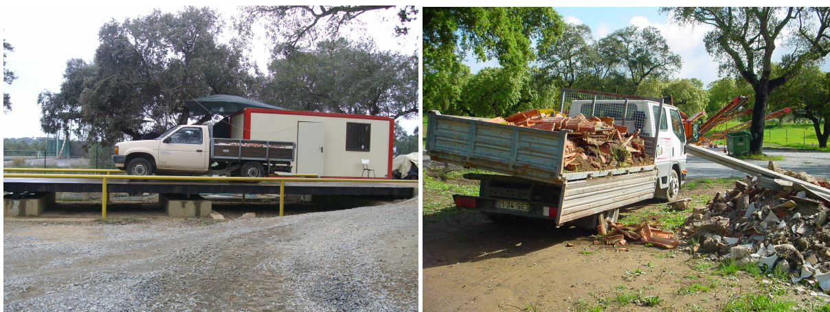
Figura 3.2 – Recepção de fracção inerte na unidade piloto de reciclagem
