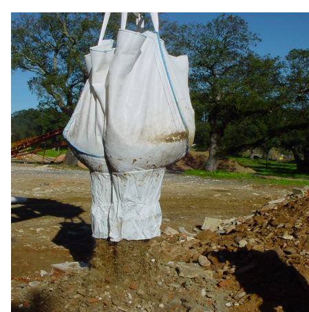
Figura 3.7 – Descarga dos diferentes tipos de big bags na unidade piloto de reciclagem
